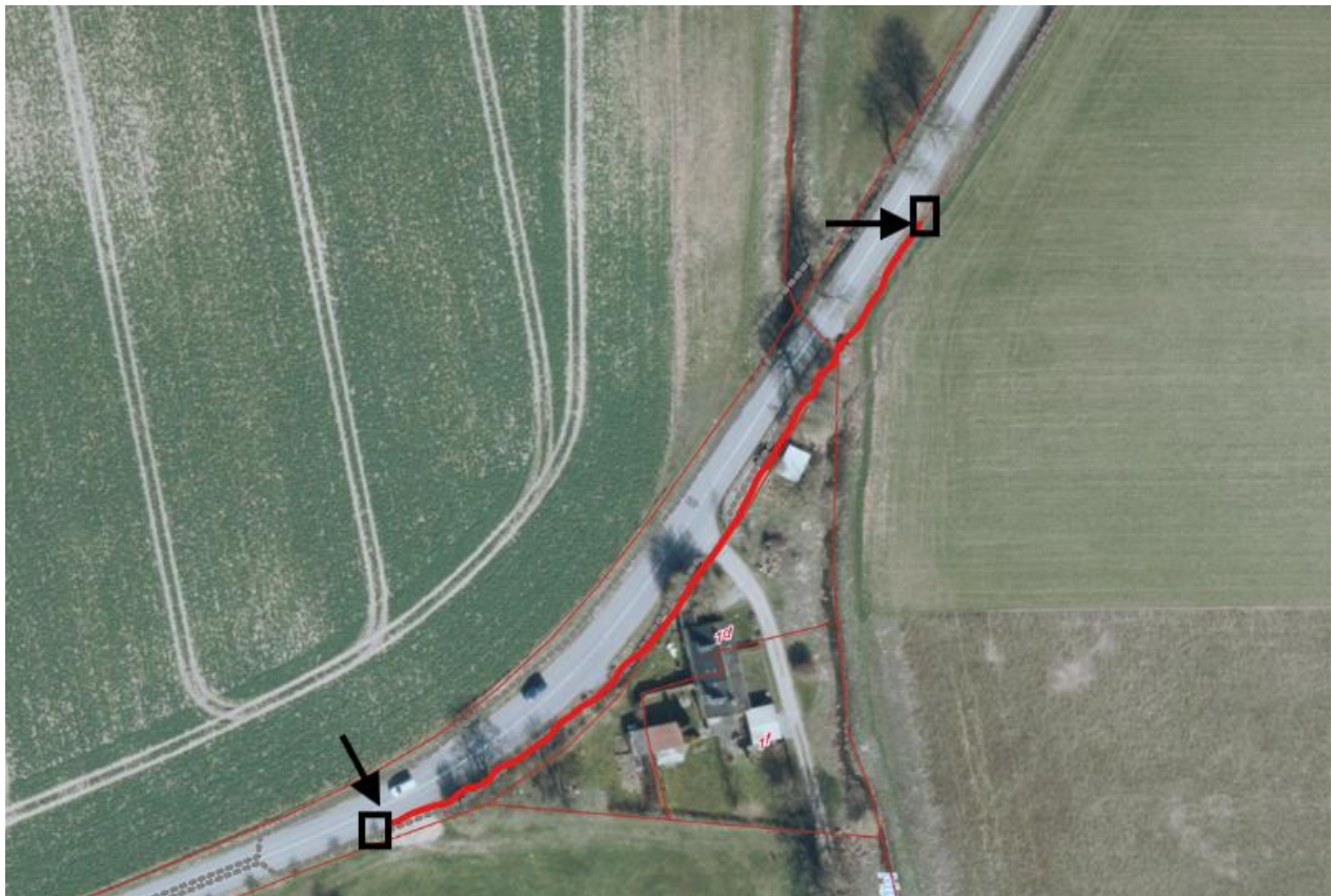
Figur 1 Viser linjeføring af kommende kabelanlæg i rød streg med pil ved afsender- og modtagegrube for underboringen v Dalbyvej.
