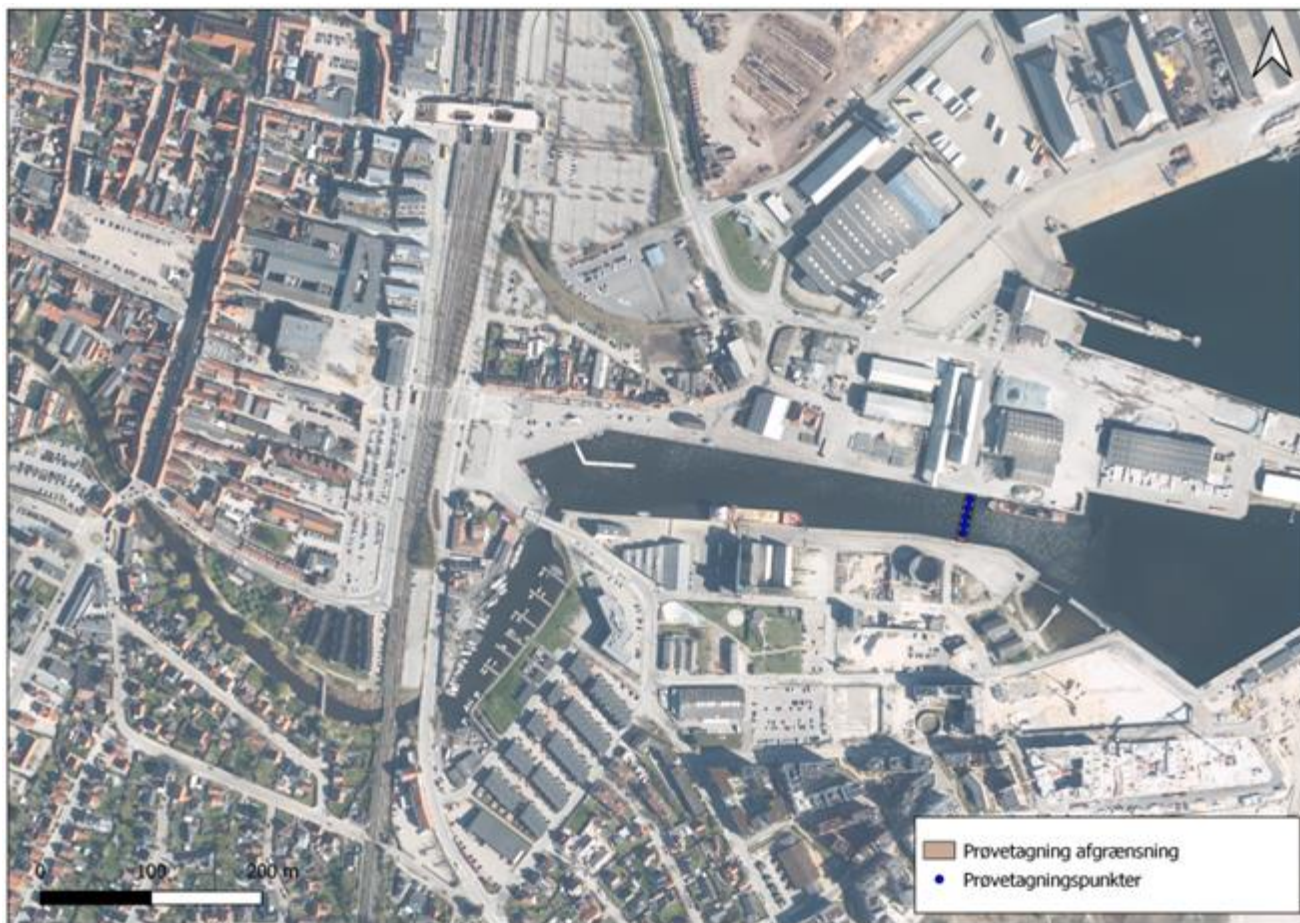
Figur 12.2: Overblik over afgrænsning af graveområde for anlæg af bundskinne til højvandsport på tværs af "slipset" i Køge Havn samt placering af prøvetagningspunkter for analyse af miljøfarlige forurenende stoffer og næringsstoffer.
