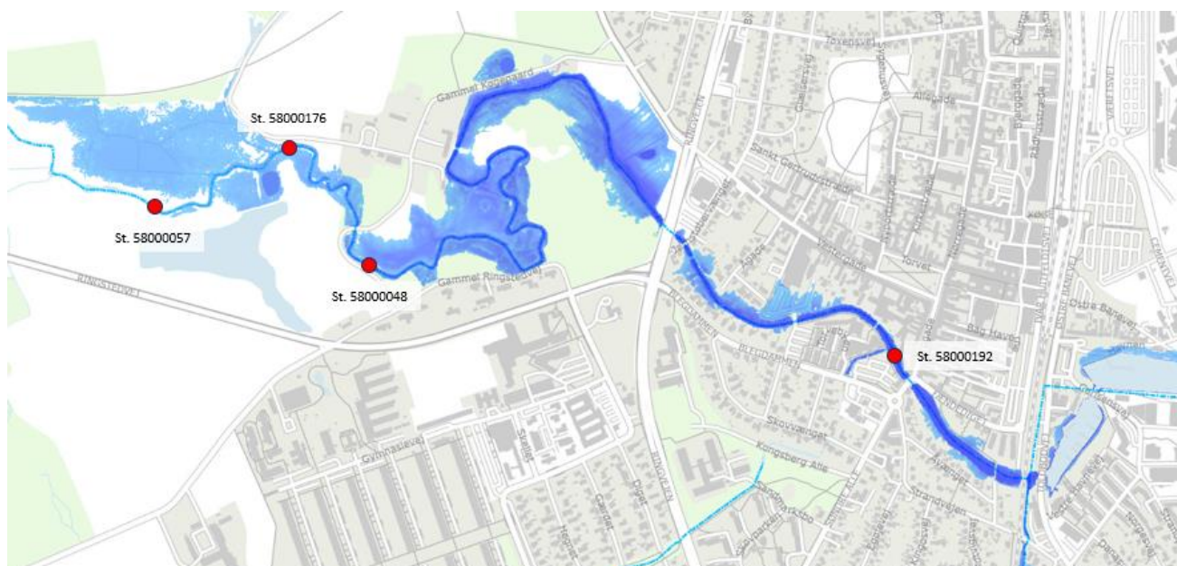
Figur 12.5: Oversvømmelsesscenario langs Køge Å ved en maksimalt tilladt vandstandskote på 1,2 m bag diget med angivelse af den geografiske placering af målestationer i Køge Å.
