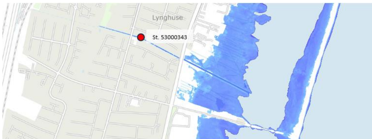
Figur 12.7: Oversvømmelsesscenarium langs Snogebækken ved en maksimalt tilladt vandstandskote på 1,1 m ved udløbet bag diget med angivelse af den geografiske placering af den nederste målestation uberørt af stuvning fra sluseport ved den pågældende vandstandskote.
