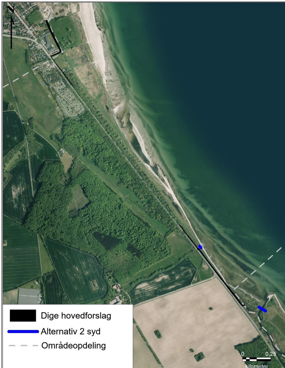
Figur 5.8 Det sydlige alternativ 2 hvor der mod nord alene etableres dige til det når Strandvejen syd for Hotel Comwell. Mod syd etableres der ved Vedskølle Å en sluse og tilsvarende helt mod syd ved kommunegrænsen ved Tryggevejle Å. Der etableres desuden skråningsbeskyttelse i dette alternativ, svarende til det tidligere hovedforslag fra 2019 som vist ovenfor på Figur 5.4.
