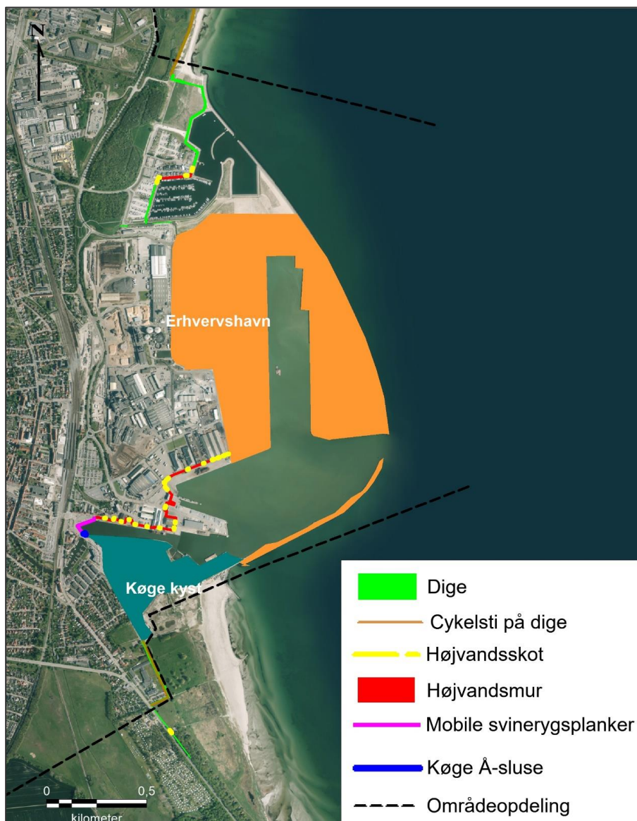
Figur 5.3 Alternativet "Tidligere hovedforslag 2019" i område 2: Løsningsforslag med højvandsdiger, højvandsmure, højvandsskot og Køge Å-sluse.
