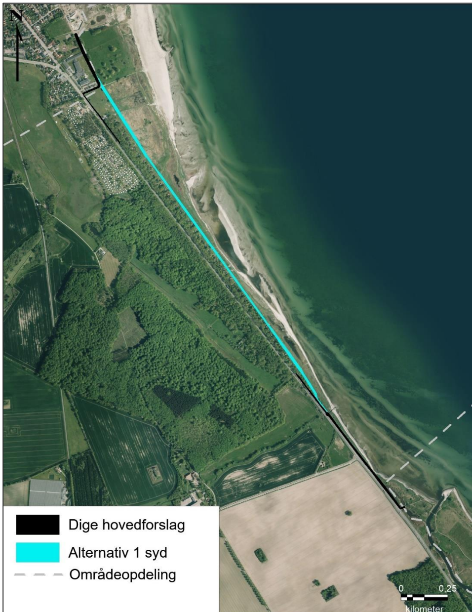
Figur 5.6 Det sydlige alternativ 1, hvor der etableres et dige søværts for strandhusene (Hovedforslag henviser til hovedforslaget fra 2019).
