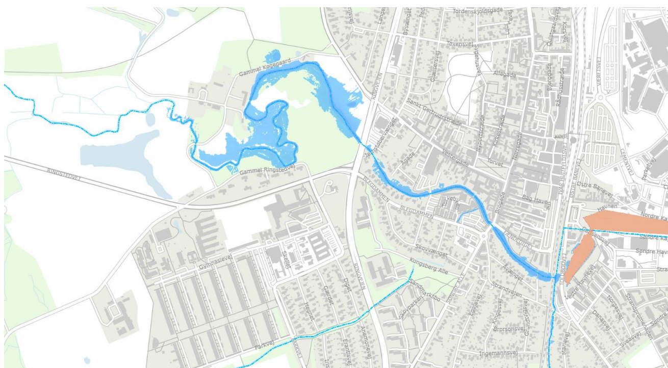
Figur 12.9 Stormen Alfrida i 2019, hvor den maksimale vandstandskote i Køge Havn blev målt til 0,91 m. Grafikken viser de oversvømmede arealer langs Køge Å, der indirekte er et udtryk for stuvningszonen opstrøms i vandløbet
