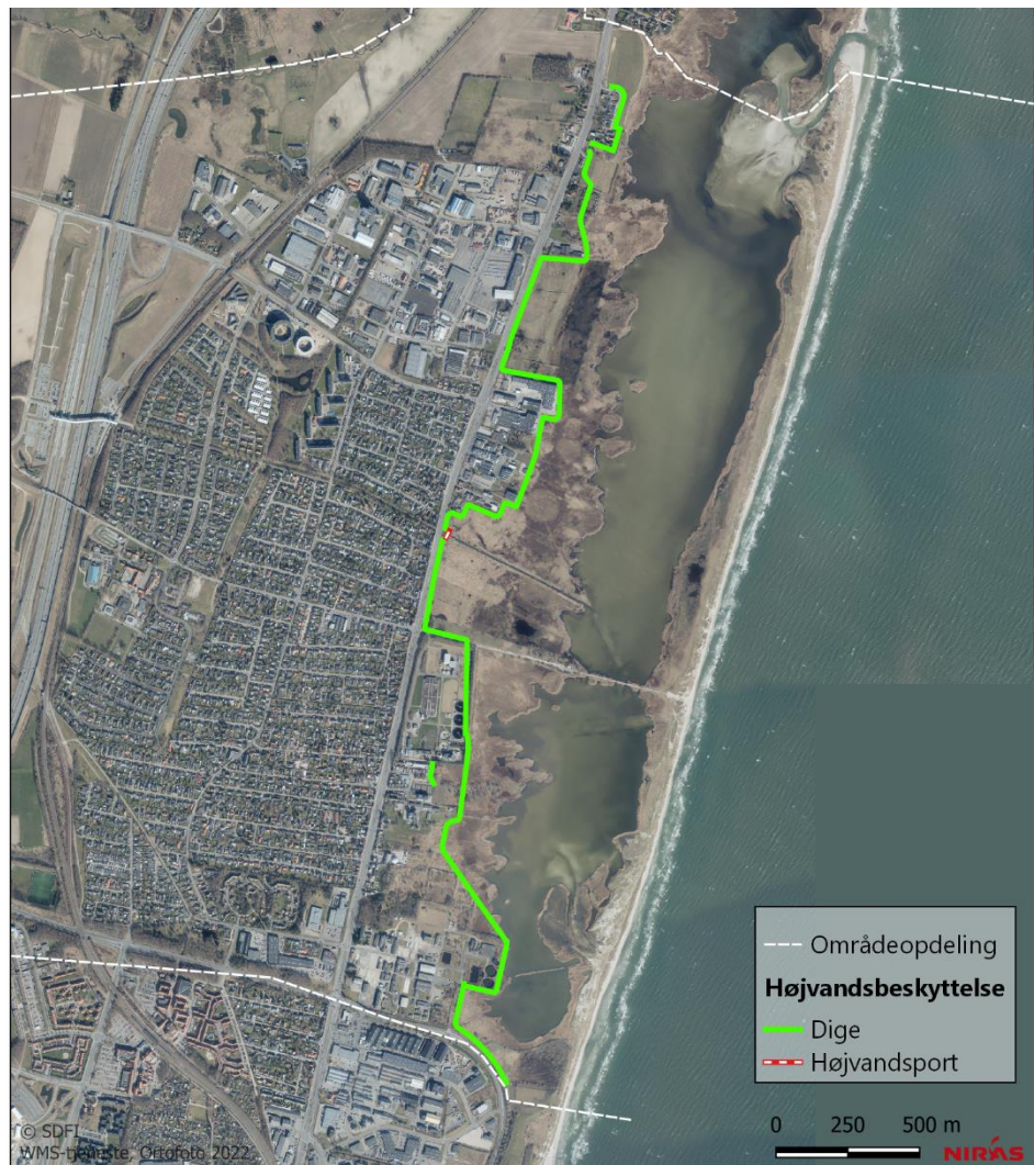
Figur 4.1 Område 1: Landdige med græsdække, der beskytter boliger og virksomheder mod oversvømmelse og med grussti på den sydlige del af diget.
