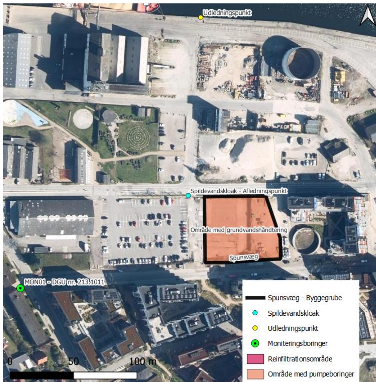
Figur 2-1 Oversigtskort for grundvandssænkning
