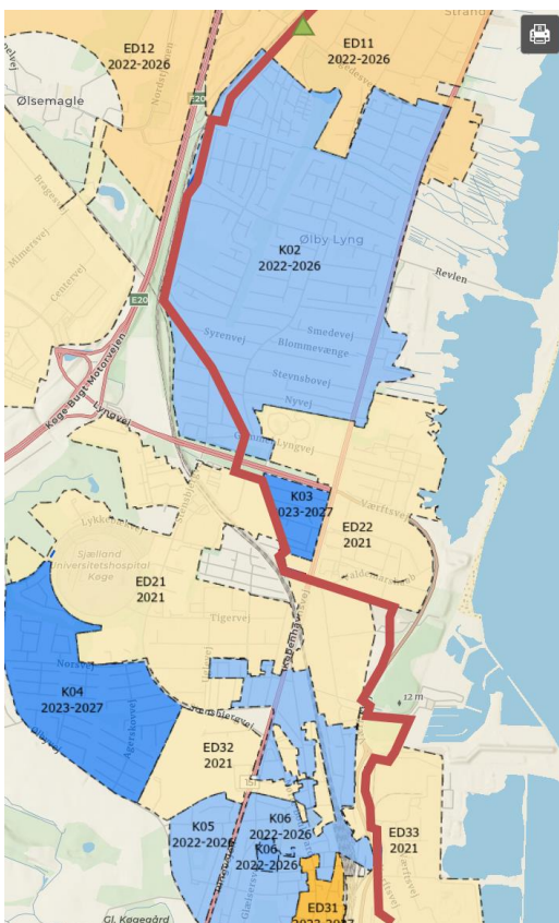
Figur 3 Oversigtskort af det nordlige Køge med angivelse af eksisterende fjernvarme transmissionsledning med rødt og den nye vekslersstation for projektscenariet ved den grønne trekant.
