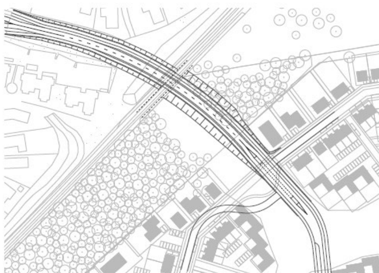
UDLÆG AF BANEUNDERFØRSEL OG SKRÄNINGSANLÆG FOR LØSNINGSPRINCIP 1.
