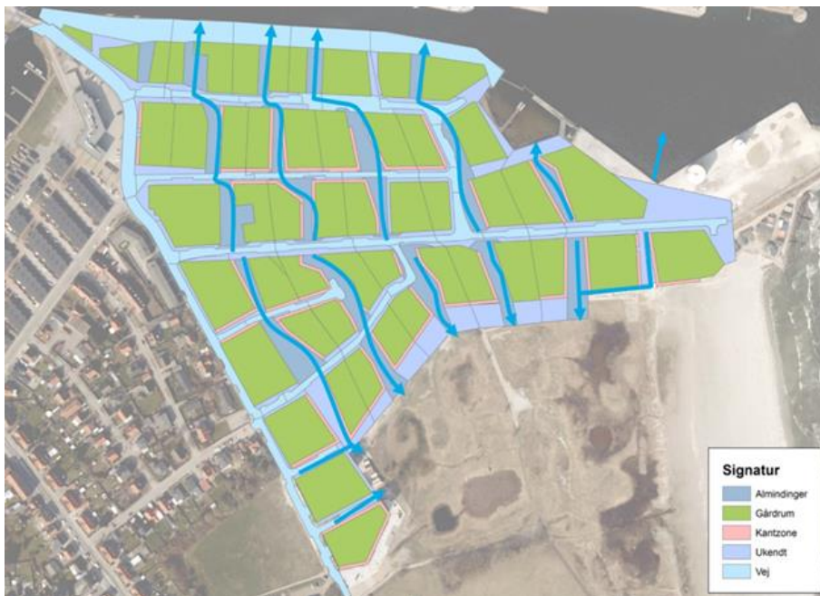
Figur med regnvands afvandingsprincip for Søndre Havn med eksisterende udløb og et nyt østligt udløb til Køge Havn. Eksisterende udløb til roklubbens bassin sløjfes.
