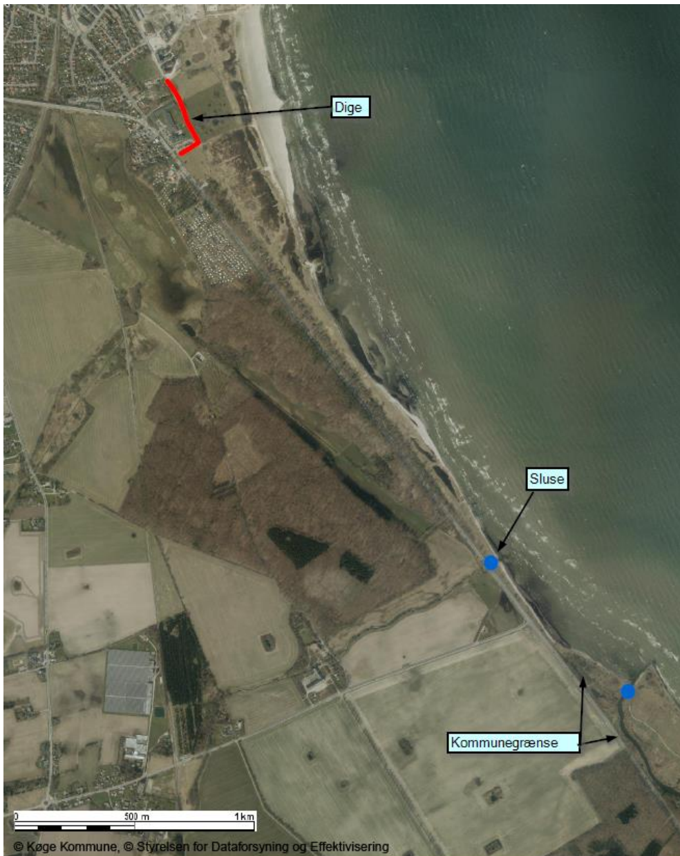
Figur 3. Den 3. løsning. Minimalistisk, hvor der kun etableres dige til Strandvejen og tilbageløb til byen forhindres via sluse i Vedskølle Å. Løsningen er ikke undersøgt på samme niveau, som de to foregående.
