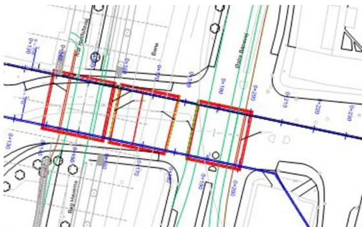
Tre selvstændige brokonstruktioner med en samlet længde på ca. 60 meter og en bredde på ca. 15 meter.
