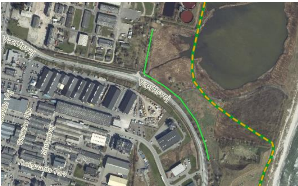
3. Justering af digetrace ved Værftsvej. Grøn/gul streg – digetrace fra dispositionsforslag. Grøn streg forslag til ændret digetrace. Der er sti på diget.
