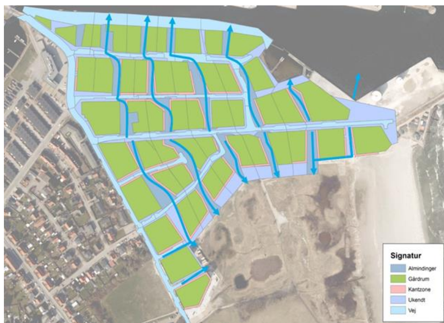
Figur med regnvands afvandsningsprincip for Søndre Havn med eksisterende udløb og et nyt østligt udløb til Køge Havn. Eksisterende udløb til roklubbens bassin sløjfes.
